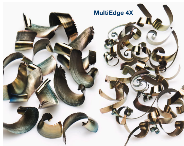
MultiEdge 4X: Kleine Späne durch Spanteilung MultiEdge 4X: Small chips because of chip division
